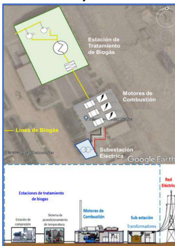
Imagen N° 3.6: Distribución de los componentes principales de la CTB Huaycoloro
